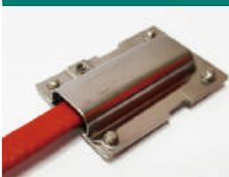
종단마감 키트로 FBL, FBH, FBX, FBZ에 사용이 가능하도록 설계됐고, 뛰어난 기계적 강도를 가지며 방폭지역에서의 사용이 가능하고, 실리콘 고무 몰딩 튜브는 설치 시 히팅 건이나 가열토치가 필요하지 않아 가열작업이 금지된 지역에서의 설치작업이 가능합니다.
